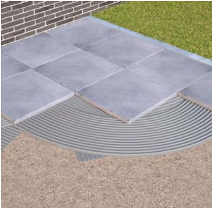
Plaatsing tegels met tegellijm op stabilisé
