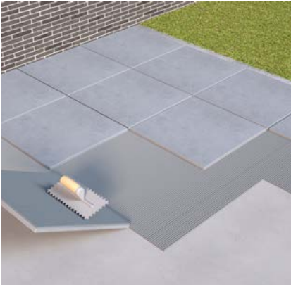
Plaatsing tegels met tegellijm dubbele verlijming
