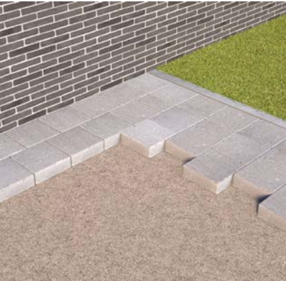
Plaatsing op stabilisatie in halfsteensverband en streklaag
