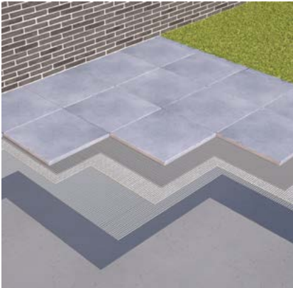
Plaatsing met drainagemat op betonplaat
