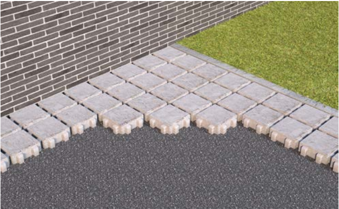
Plaatsing waterdoorlatende klinkers op split in verband met streklaag
