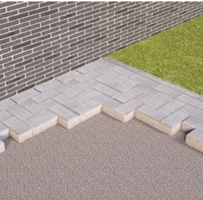
Plaatsing op stabilisatie in elleboogverband en strekklag
